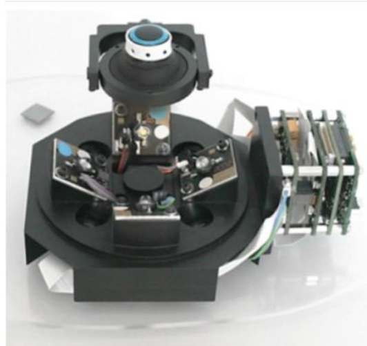
Augenoperations-Simulator (Detail): Lebensgroßes Augenlinsen-Modell mit 3D-Bilderfassung
